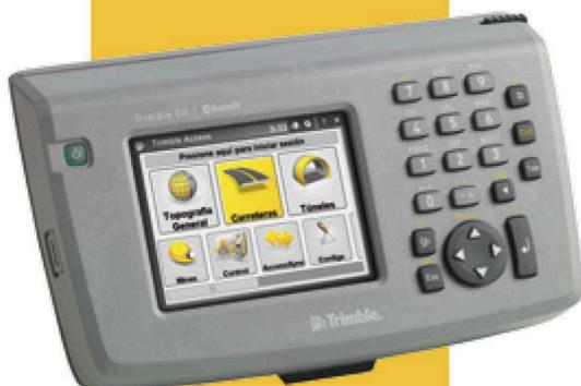
1 El controlador Trimble CU ha sido diseñado para ser compatible con los últimos sistemas topográficos de Trimble, incluyendo el sistema GNSS Trimble R8, la estación total Trimble S6, la estación total Trimble S8 y la Trimble VX Spatial Station.
